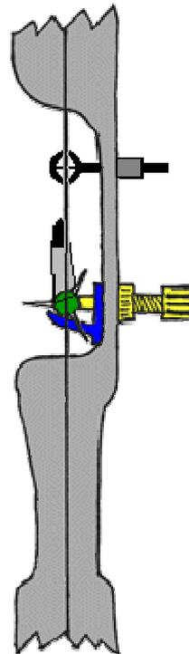
Avant de passer aux **réglages fins**, vérifier l'adaptation flèche-arc en tirant à 15 mètres des flèches empennées et sans plume. Les flèches sans plume doivent être dans le même groupement que les autres.
