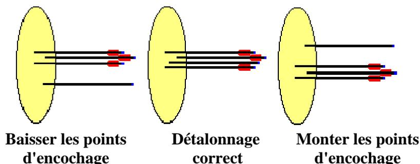
Si la méthode de réglage fin vous indique de descendre en dessous de l'horizontal (détalonnage négatif), c'est que le tiller est mauvais et vraisemblablement inversé.
